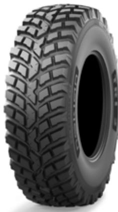
Derzeit hat LU Blunk drei Traktoren mit Nokian-Blockprofilreifen (TRI 2 Extreme Steel) der Größe 650/65 R 42 testweise ausgerüstet.
